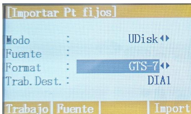
Utilizamos nuevamente las flechas para buscar el formato de exportacion que sera GTS-7, destacando que se puede utilizar diferentes formatos como CSV, HTF, GSI, entre otros.
