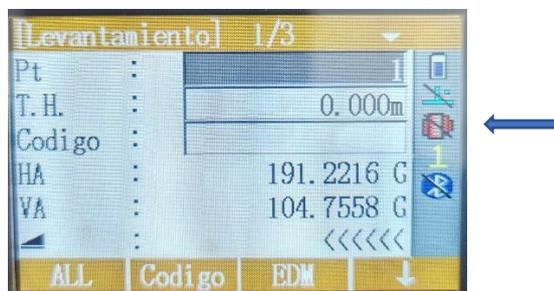
Para ello nos vamos a Config de EDM e indicamos el reflector a utilizar.
